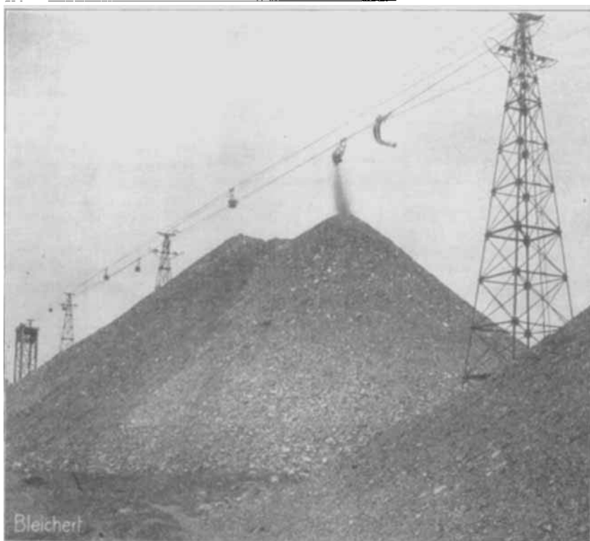
Abb. 1. Aufstapeln von Fördergut auf Halde durch selbsttätiges Kippen von Drahtseilbahnwagen auf freier Strecke.
